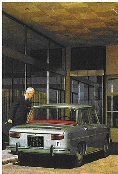
Koncepci s motorem uloženým podélně za poháněnou zadní nápravou a převodovkou před ní se Renault 8 velmi podobá našim škodovkám z let 1964 až 1990
