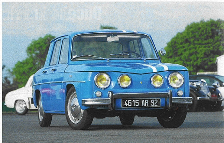
Model Gordini poznáte na první pohled podle čtyřkové masky. Vnější svítlna ale musí mít větší průměr než vnitřní. Stejný průměr znamená úpravu vzniklou u nás.
