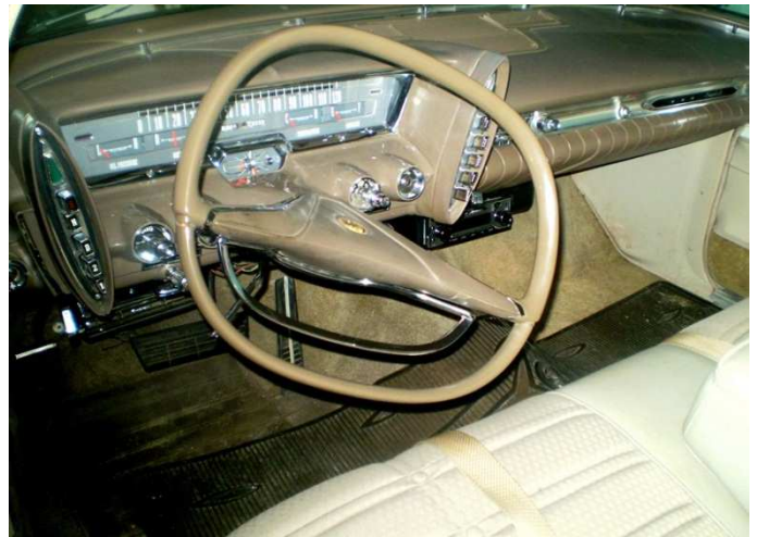
Amerika na první pohled (Imperial 1963) - oválný volant, vlevo tlačítka automatiky, vpravo ovládání klimatizace. Určitě oslní, ale v podstatě je jednoduchá ...
