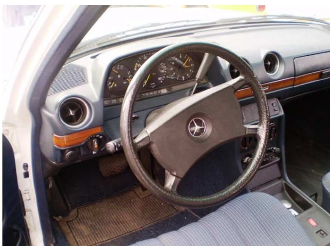
Rarita na druhý pohled: M.B. 200 D (piáno) s voličem automatiky pod volantem! Poslední model, který tuto zajímavost nabízel!
