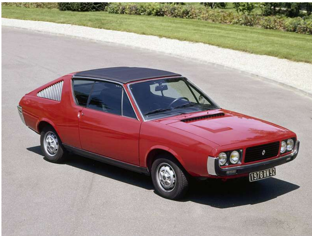
Dnes už poněkud zapomenuté kupé Renault 17 debutovalo v roce 1971. Postaveno bylo na upraveném podvozku „dvanáctky“ a byl to první vůz značky Renault, u kterého bylo použito vstřikování paliva (model R17 TS).
