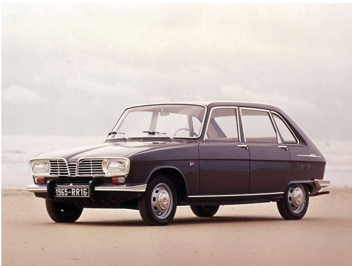
Vůz roku 1965 - Renault 16. První automobil na světě s karoserií typu hatchback a první Renault, který získal ocenění „Automobil roku“.
