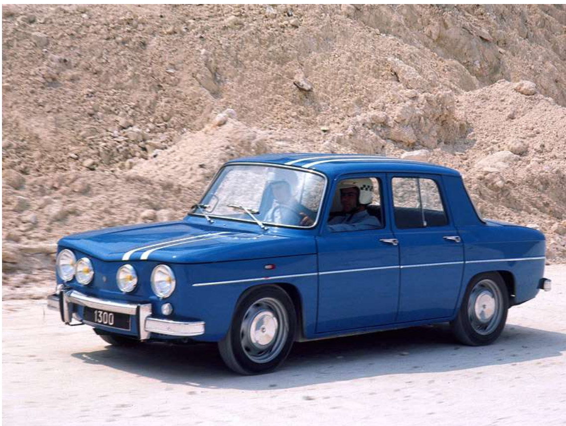
„Meteor na francouzské modři“ - Renault 8 Gordini s motorem o obsahu 1 255 cm 3 a výkonu 105 k. Výsledek spolupráce firmy Renault a konstruktéra Amédée Gordiniho.
