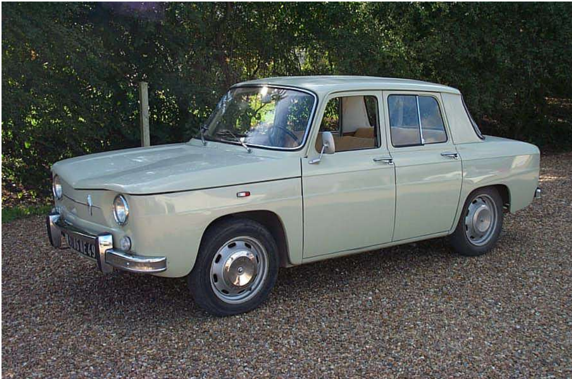
Následník Renaultu Dauphine – oblíbený Renault 8, který se vyráběl v letech 1962 – 1973. První sériově vyráběný vůz na světě s kotoučovými brzdami na všech čtyřech kolech. Na jeho designu se významně podílel průmyslový designer Philippe Charbonneaux.
